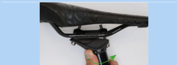
Illustration 206 : Ouvrir le réglage de la hauteur
