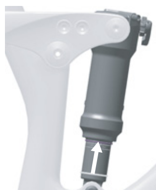
Illustration 100 : Déplacer le joint torique sur l'amortisseur arrière
