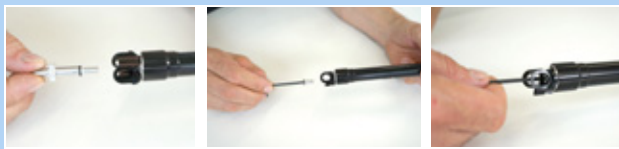
Illustration 174 : Fixer le couvercle de valve de la cartouche
