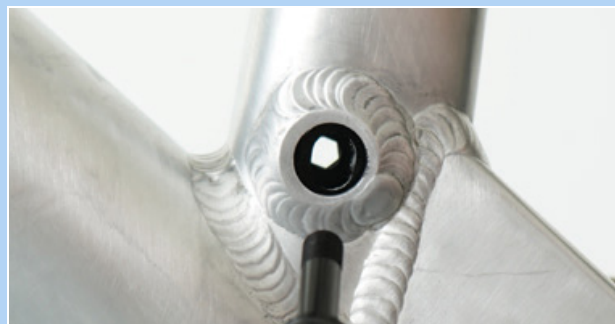
Illustration 215 : Trou de l'interface Postpin
