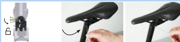
Illustration 155 : Placer le mécanisme de réglage de la hauteur en « position ouverte »
