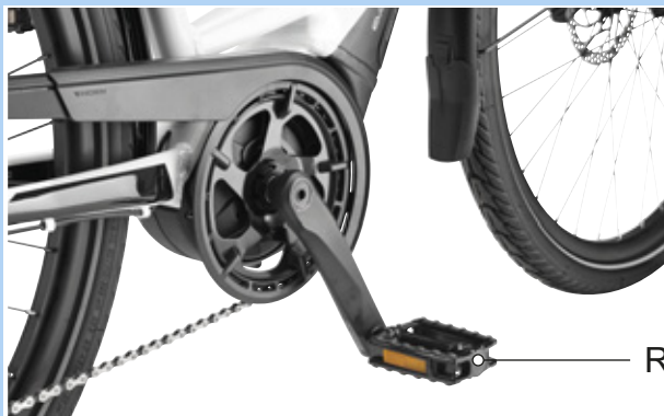
Illustration 66 : Pédale R dans le bras de manivelle droit
