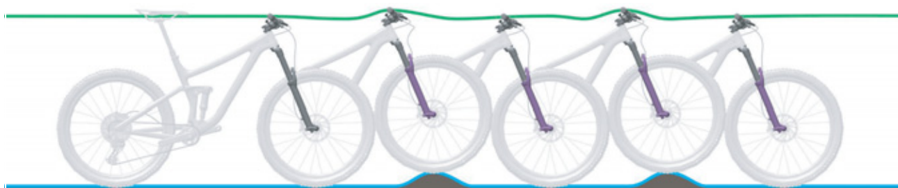
Illustration 101 : Comportement optimal de la fourche
