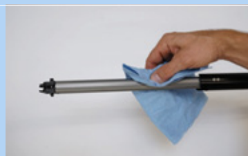
Illustration 208 : Nettoyer la rainure de guidage longitudinale
