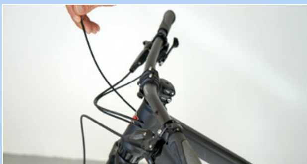
Illustration 214 : Accrocher le capuchon d'extrémité
