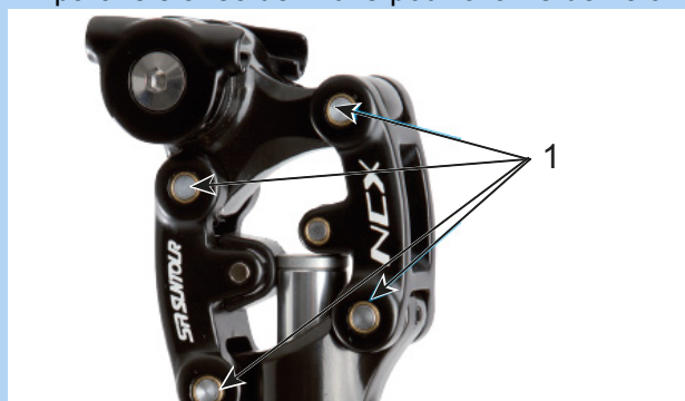
Illustration 154 : Points de lubrification de la tige de selle suspendue SR Suntour
