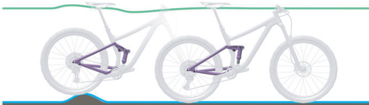
Illustration 105 : Comportement optimal de l'amortisseur arrière sur des irrégularités
