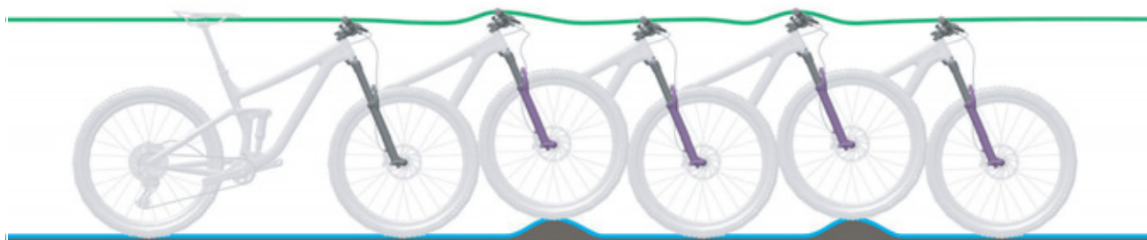
Illustration 11 : Comportement optimal de la fourche
